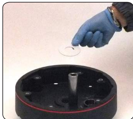
27. Remove the washer n°26
