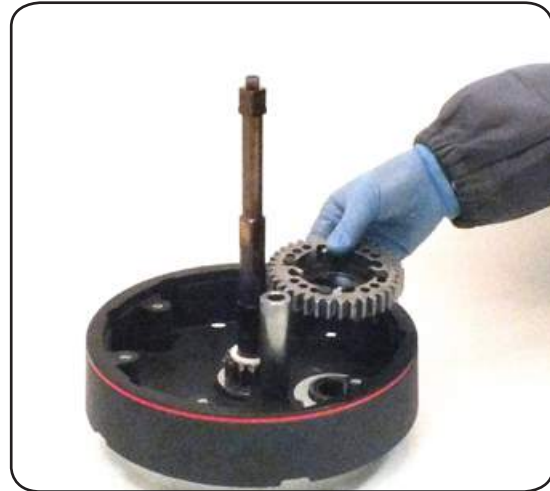
23. Remove the gear n°4
