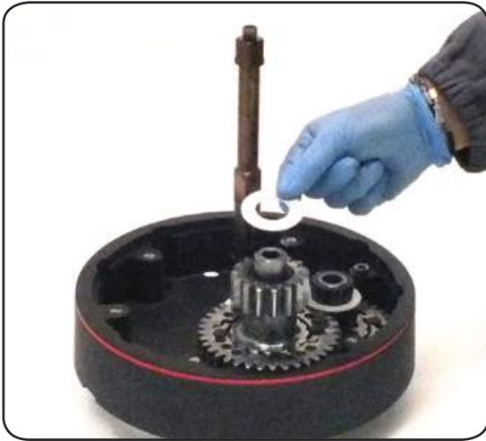
16. Remove the washer n°10
