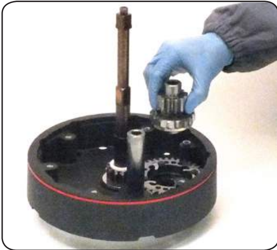
22. Slide out the gear assy n°9
