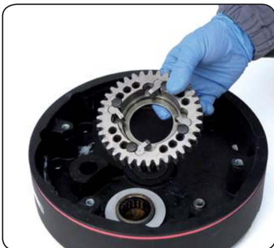
21. Remove the gear n°14
