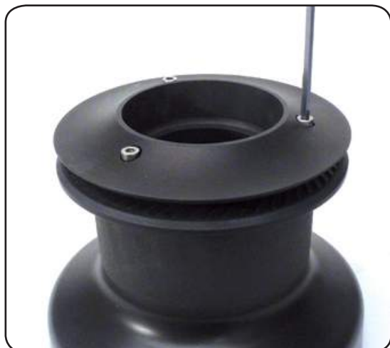
I. Unscrew the 3 screws n°17 ( \approx 4\text{Nm}/35\text{ in-lb} )
