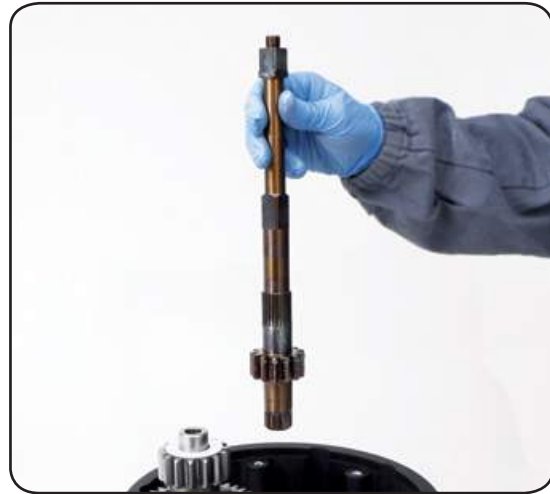
12. Slide out the shaft n°28
