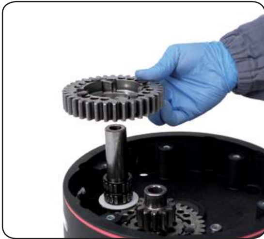
17. Slide out the gear n°10
