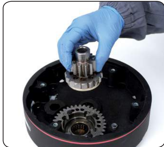
20. Remove the pinion n°13
