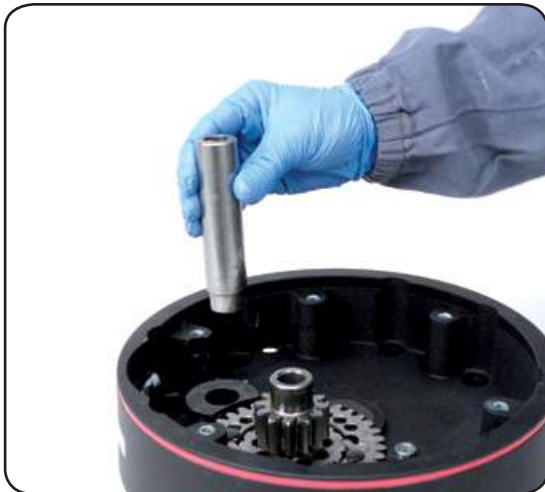
19. Remove the shaft n°7
