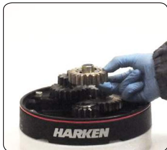
12. Remove the gear n°6, pawls carrier n°3 and the washer n°7
