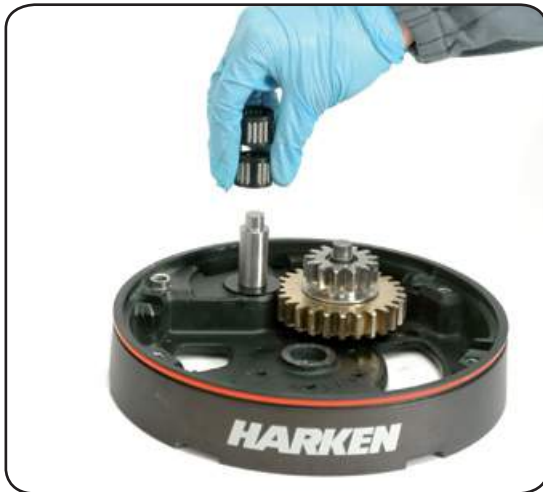
14. Remove roller bearings n°15
