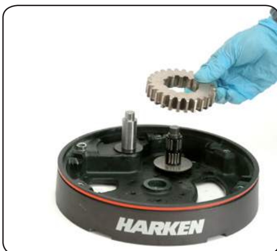
16. Remove the gear n°10
