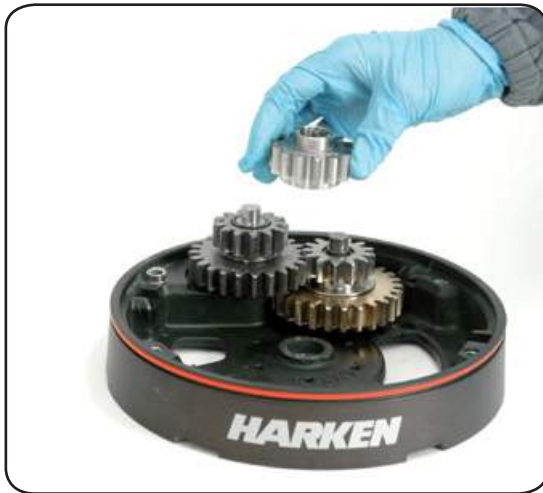
12. Remove the gear n°2
