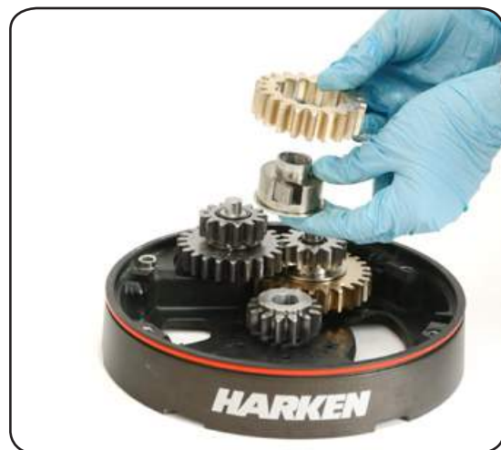
11. Remove the gear n°6, pawls n°3 and the washer n°7
