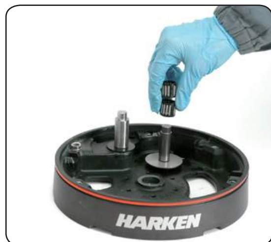
17. Remove roller bearings n°12
