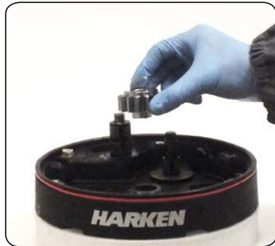
16. Remove the gear n°2
