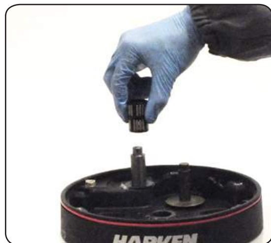
18. Remove roller bearings n°15
