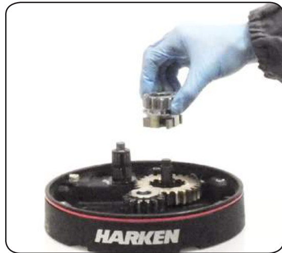
14. Remove the pawl carrier n°11
