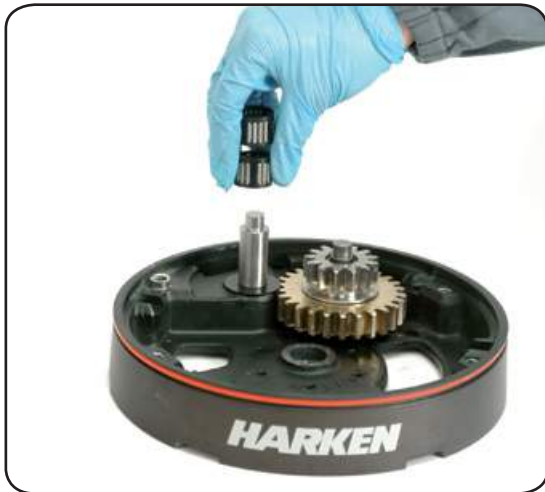
14. Remove roller bearings n°15
