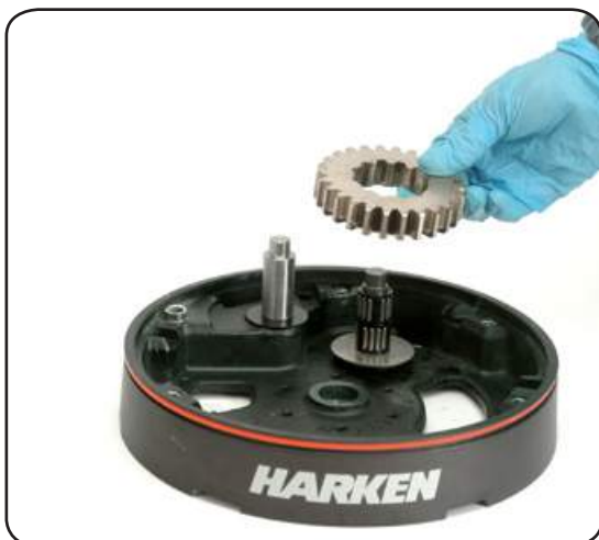
16. Remove the gear n°10
