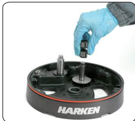
17. Remove roller bearings n°12
