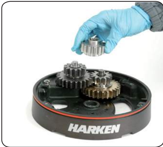
12. Remove the gear n°2
